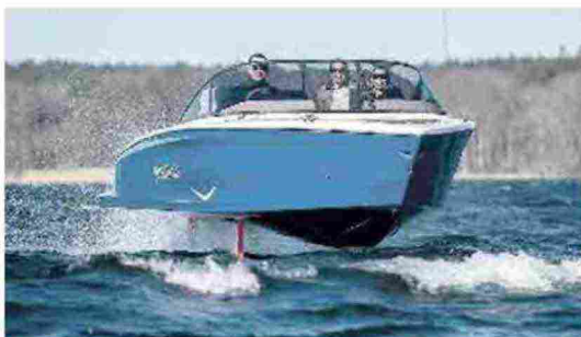
Il motoscafo C8 degli svedesi di Candela Boats, dotato del fuoribordo C-POD che spinge l'imbarcazione a raggiungere i 30 nodi di velocità per un'autonomia di oltre 50 miglia. In basso gli interni di un mega yacht eco-friendly.
